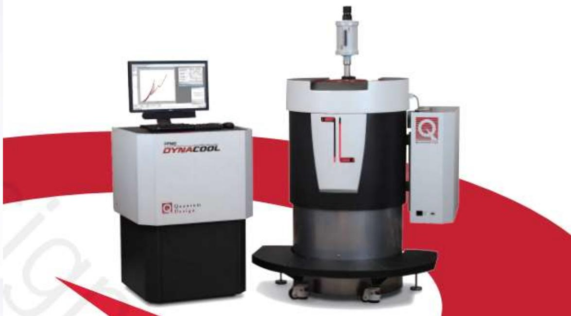
所谓完全无液氦，是说我们不需要准备液氦，但是它的运行还是需要液氦的。开机时，它自带压缩机把氦气压缩成液氦，自己存在一个氦气闭循环系统，内部只有少量的液氦就可以维持低温和实现降温。
