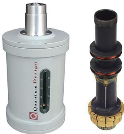
图 7 VSM 电磁力驱动马达及线圈
