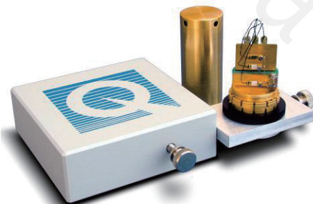
图 26 热输运样品安装平台
