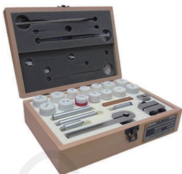
图 37 磁测量高压腔的专用工具箱
