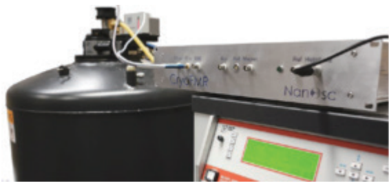
图 44 在 PPMS 上进行低温强磁场下的 FMR
