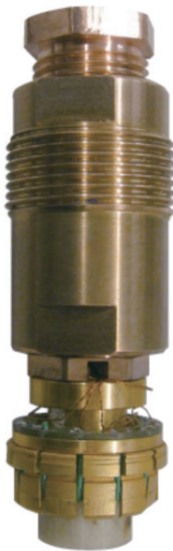
图 36 已安装好的电测量高压腔腔体
